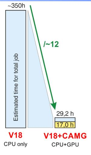
2 Intel Xeon 6146 (40 cores) + Nvidia Tesla V100 - 16GB
