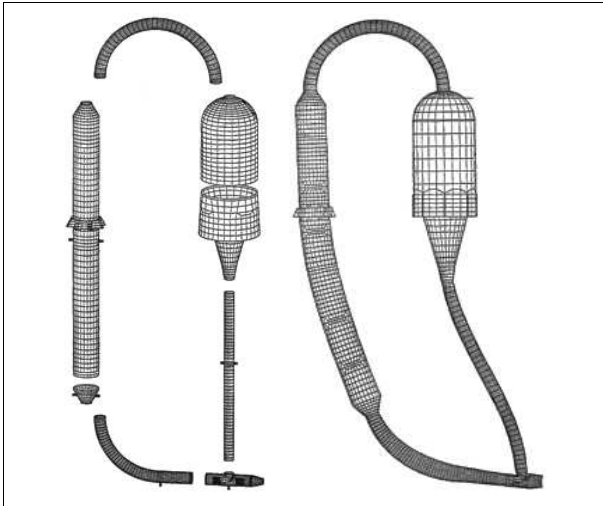
Abbildung 123: Eigenform eines Reaktors
