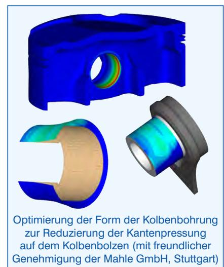
Optimierung der Form der Kolbenbohrung zur Reduzierung der Kantenpressung auf dem Kolbenbolzen (mit freundlicher Genehmigung der Mahle GmbH, Stuttgart)
