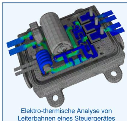
Elektro-thermische Analyse von Leiterbahnen eines Steuergerätes
